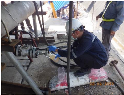
รูปที่ 3-1 การติดตามตรวจสอบคุณภาพน้ำทิ้งจากการทดสอบท่อ ด้วยวิธีทางชลสถิต (Hydrostatic Test)
